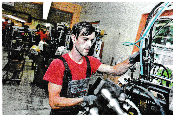
Effizienz ist das A und O. EWS-Mitarbeiter Maik Heidrich arbeitet an der neuen Fersenseiten-Klebezwick-Maschine.
